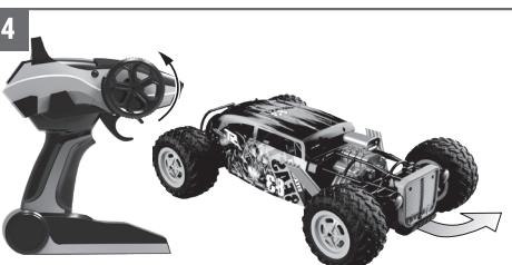
При вращении руля пульта против часовой стрелки автомобиль поворачивает влево.
